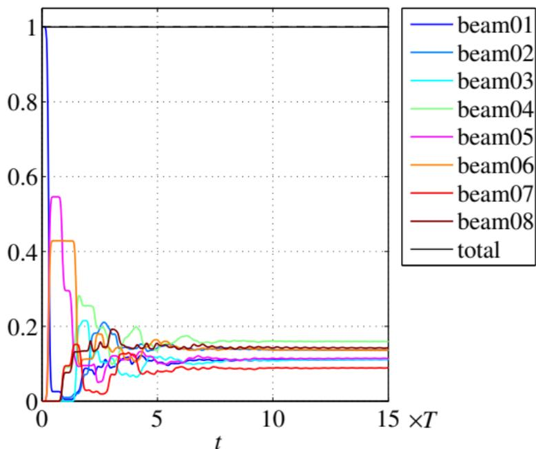
Évolution de la densité d'énergie totale dans chaque poutre en fonction du temps
