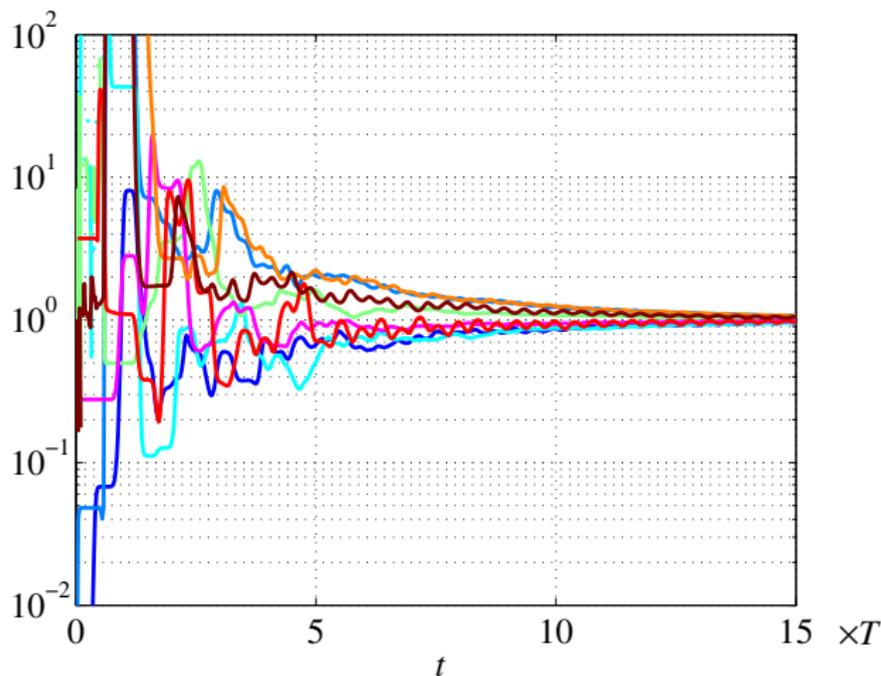
Évolution de  $\frac{c_T c_T^p(t)}{2 c_P c_P^p(t)}$  dans chaque poutre en fonction du temps
