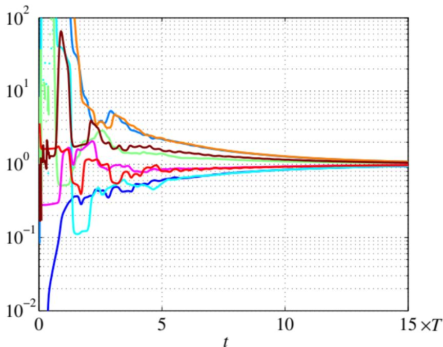
Évolution de  $\frac{c_T e_T^p(t)}{2 c_P e_P^p(t)}$  dans chaque poutre en fonction du temps
