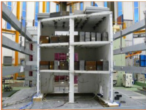
Maquette béton du benchmark SMART
